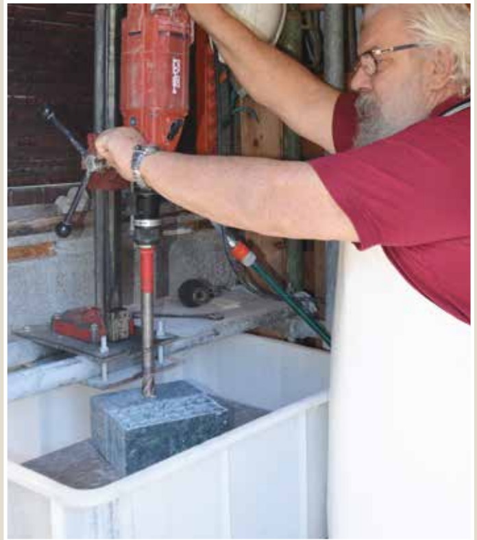
Kernbohrung aus dem Block
