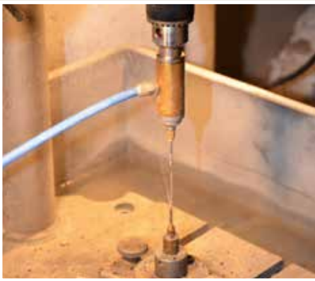
Hochpräzisionsbohrgerät mit Wasserstrahl
